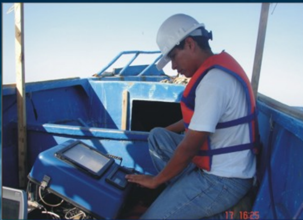
➤ Hidrógrafo H&O realizando la configuración inicial de escala gráfica en una ecosonda Syquest Bathy 500MF. - Bayobar - Miskimayo - Feb 2006.
